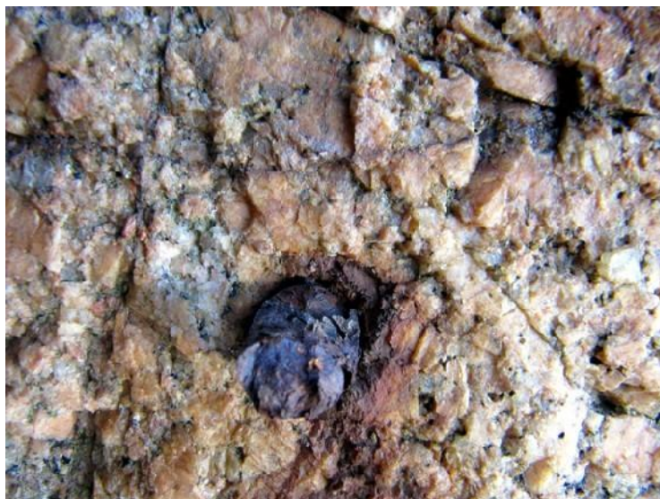
Toco quebrado de um grampo de inox que falhou apenas com o peso do corpo do escalador na via Exu nas Paredes de Cima, Falésia dos Orixás, Barra de Guaratiba, Rio de Janeiro.
