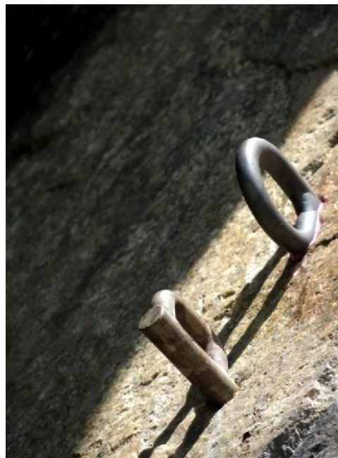
Grampo de titânio Tortuga fixado com o olhal para baixo, ao lado de outro de inox na Fissura Stalingrado , Pico do Perigoso, Barra de Guaratiba, Rio de Janeiro. Foto: André Ilha
