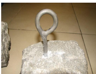
Teste 1: grampo de Ti chinês batido com o dispositivo desenvolvido.
