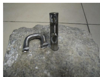
Teste 3: grampo inox 1/2” com furo metade 13 mm, metade 12 mm.
