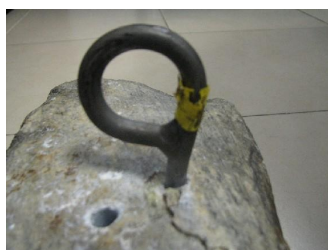
Teste 1: grampo de Ti chinês batido diretamente no olhal.
